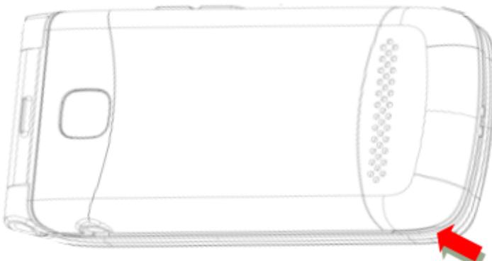
3. Sollte der Akku im Gerät sein, bitte entfernen Sie diesen.
